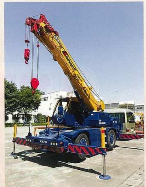
移動式クレーン
